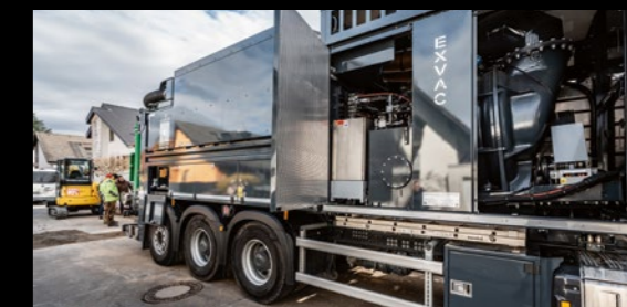
Die Innenmulde des Exvac fasst 10,5 m³
